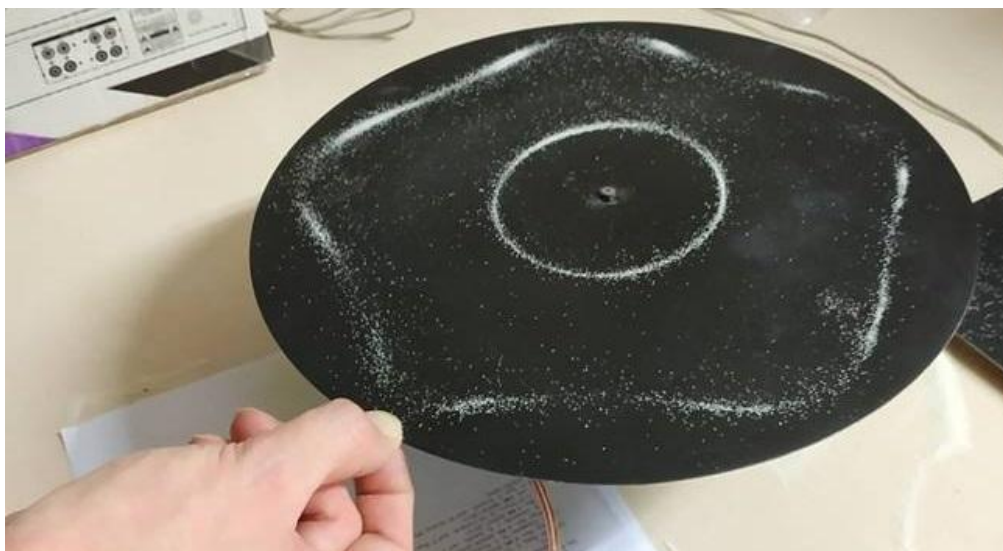
Obr. 4: Vznik obrazce z jemné krupice na kruhové desce s pevným koncem
