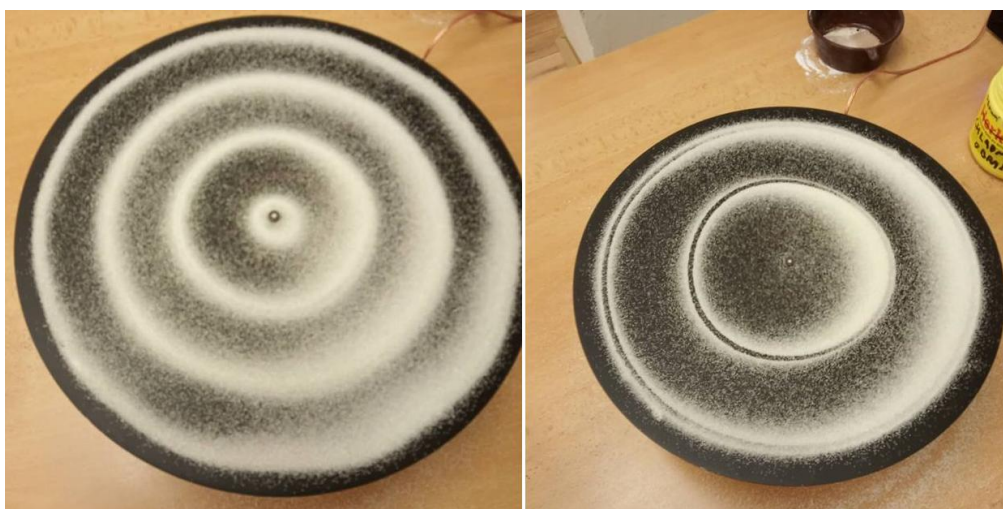
Obr. 3: Obrazce vznikající při dvou různých frekvencích na kruhové desce při volném konci
