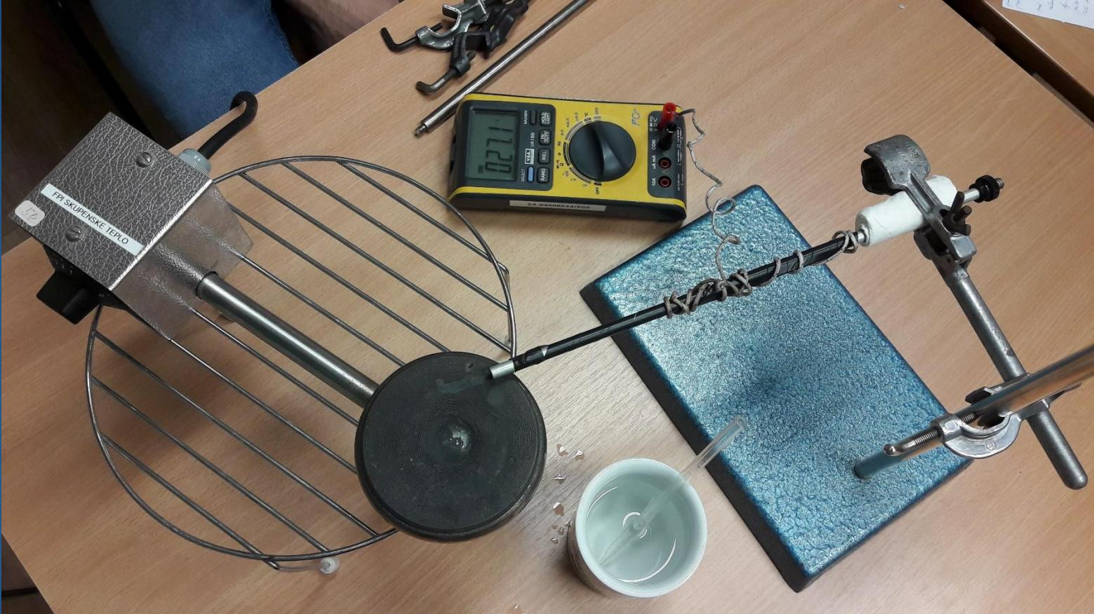
Foto 1: Experimentální aparatura - plotna, dotykový digitální teploměr, pipeta, stojan
