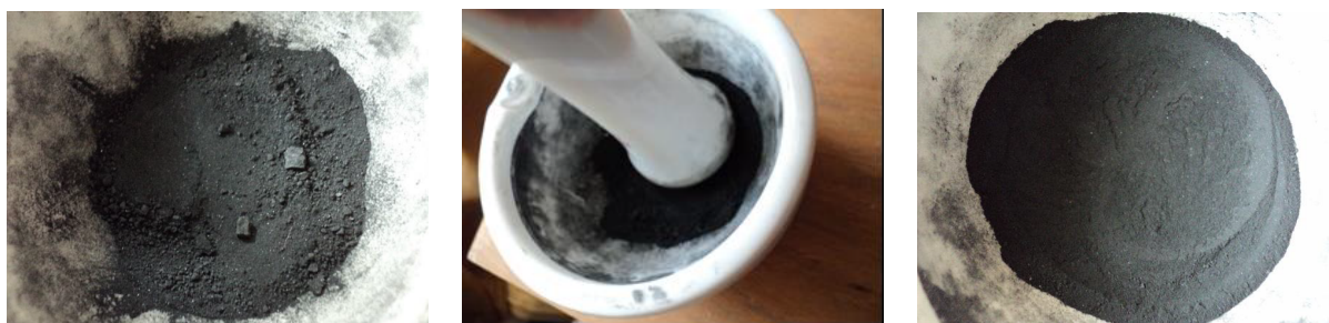
Obr. 2: Hrubá zrna vzniklá po roztlučení supravodičů (vlevo), drcení směsi v třecí misce (uprostřed), jemný prášek připravený k pálení (vpravo)
