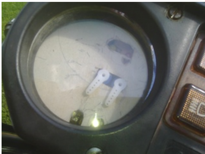
Obrázek 7: Ukazatelé. Jsou hnány servomotorky se zpětnou vazbou. Ukazatel vlevo zobrazuje otáčky motoru a ukazatel vpravo zobrazuje palivo v nádrži.
