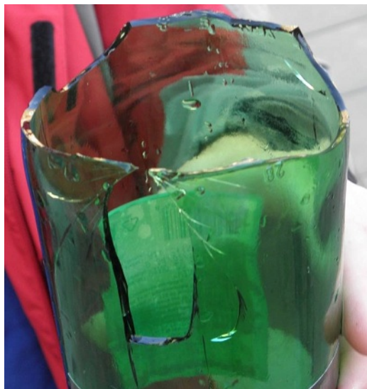
Obrázek 1: Nejčastější typ struktury prasklin na rozbité lahvi
