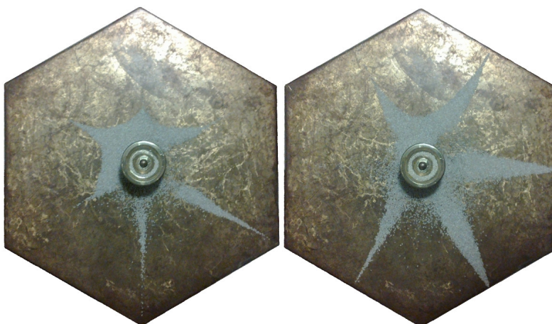
Obr. 4: Uzlové čáry na šestiúhelníkové desce. Vlevo: rozkmytání desky ze středu hrany, vpravo: rozkmytání z rohu.
