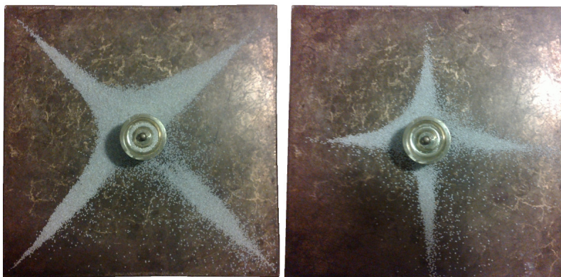
Obr. 3: Uzlové čáry na čtvercové desce. Vlevo: rozkmytání desky ze středu hrany, vpravo: rozkmytání z rohu.
