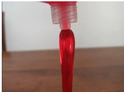
Obr. 5 Výtok neneutronovské kapaliny – Barrův efekt
