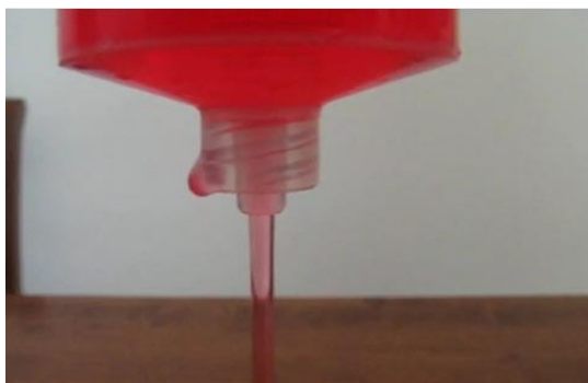
Obr. 4 Výtok newtonovské kapaliny
