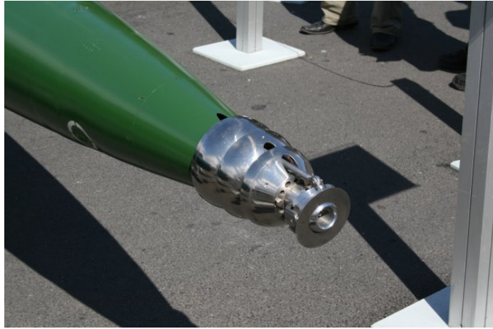
Obr. 2: Tupá špička torpéda škval
