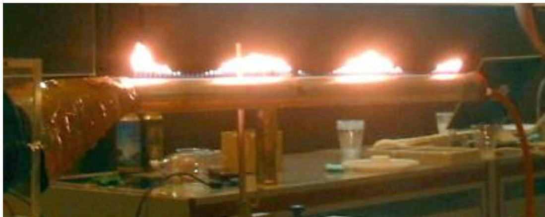
Obr. 1 Příklad Rubensovy trubice s vysoce intenzivním zdrojem zvuku. V určitých místech je vzduch z okolí nasáván do trubice[4].
