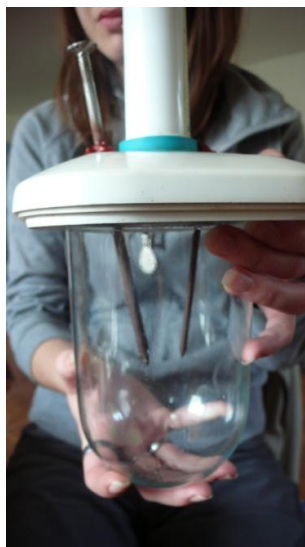
Obr. 5 Odsávání vzduchu z vlastní plazmové koule
