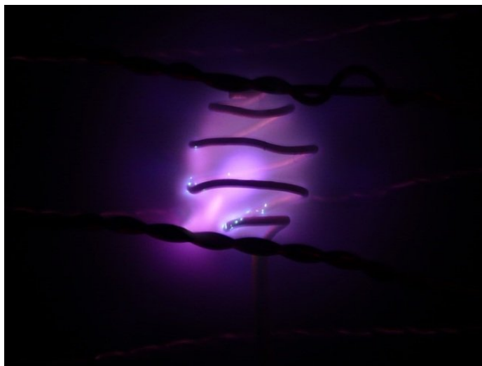
Obr. 2 Plazma ve vnitřní elektrodě s viditelným bugle jetem (16 Pa, 400 V)
