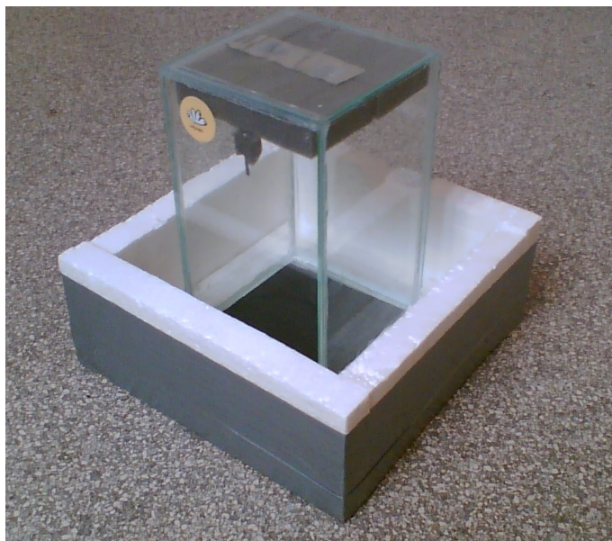
Obr. 7 Sestavená difúzní mlžná komora
