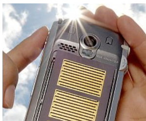
Obrázok 4: Výsledné zapojenie MT s fotočlánkom.
