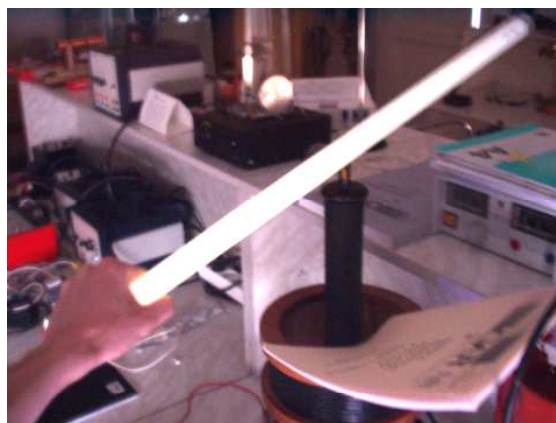
Obr. 1: Běh Teslova transformátoru
