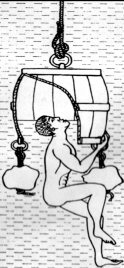
Obr. 3 Za předchůdce potápěčských zvonů jsou považovány ponořené sudy, v nichž se potápěči nadechovali.
