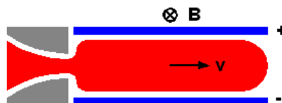
obr. 1. Schéma MHD generátoru
